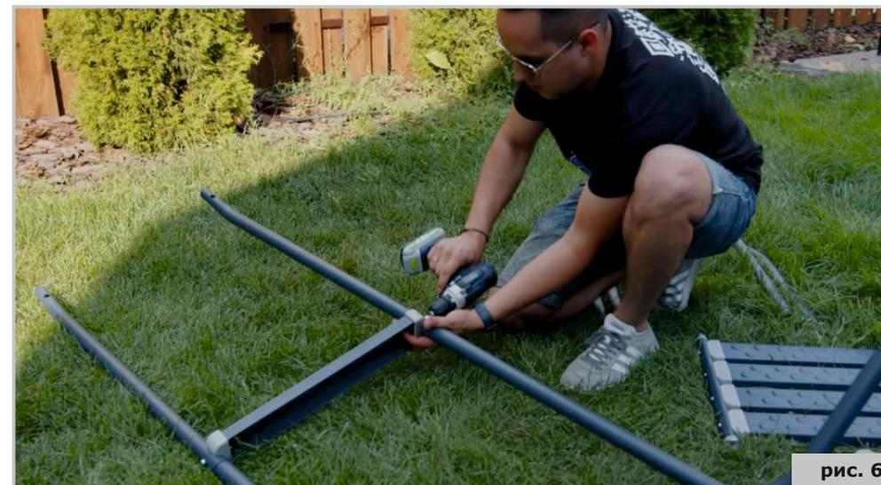
Прямые стойки имеют отверстия еще под ДВЕ ступеньки, аналогичным образом выполняем монтаж ступеней с помощью крепежной фурнитуры.
